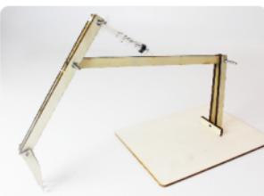
步骤五 安装小臂注射器
