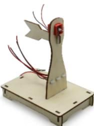
步骤五：卡紧电机和导线头
