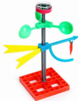
风向指示仪是一种应用最广泛的测量风向的主要仪器。在风的作用下，尾翼产生旋转力矩使风向标转动，并不断调整指向杆指示风向。风速仪则是利用风杯在风作用下的旋转速度来测量风速。
